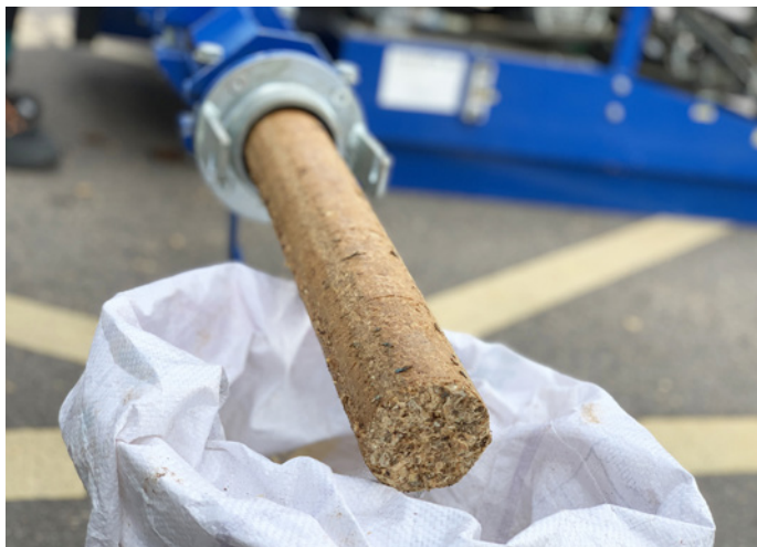
Výroba briket z mangových pecek.
